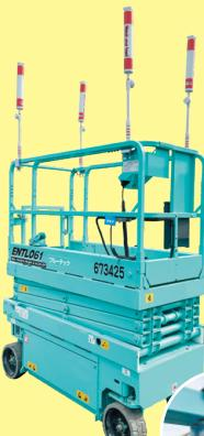
上昇中に障害物に接触するとアラートが鳴る。軽く接触しても、ソフトな素材なので大きなダメージはない。
