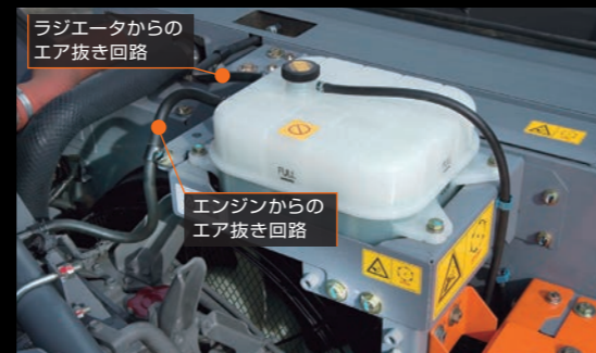
エキスパンションタンク
