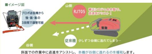
斜面での作業中に直進をアシストし、本機が谷側に逸れるのを緩和します。
