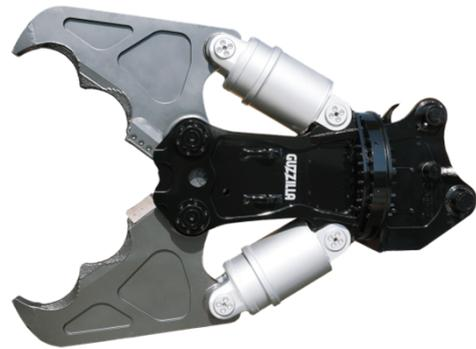
ツインシリンダー搭載のガジラ大割機DSは、2本のアームが同期(シンクロ)する同期リンク機構を搭載。アームのシンクロ動作により、2本のアームの開閉がツインシリンダーの油圧バランスに左右される事無く本体の中心にて均等に開閉しますので、破碎対象物に対して狙いをつけ易く、常に品質の高い破碎作業を行えます。また、アームパワーのバランスも向上し、破碎対象物への片利きやねじれ等を防止します。ツインシリンダー搭載でも軽量で、あらゆる現場で使用頂けます。ガジラ大割機DSは、コンクリート構造物から基礎解体作業に威力を発揮する大割破碎機です。
